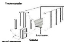
Satz- oder Kastentrockner Quelle: TFZ - Technologie- und Förderzentrum Bayern
