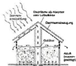
Trocknung durch Luftkollektor Quelle: TFZ - Technologie- und Förderzentrum Bayern
